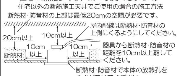
屋内配線は断熱材・防音材の上側にくるようにしてください。
