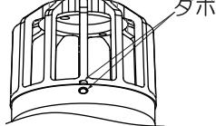
※灯具とコーンのダボ位置が縦方向に揃うまで締め付けてください。
