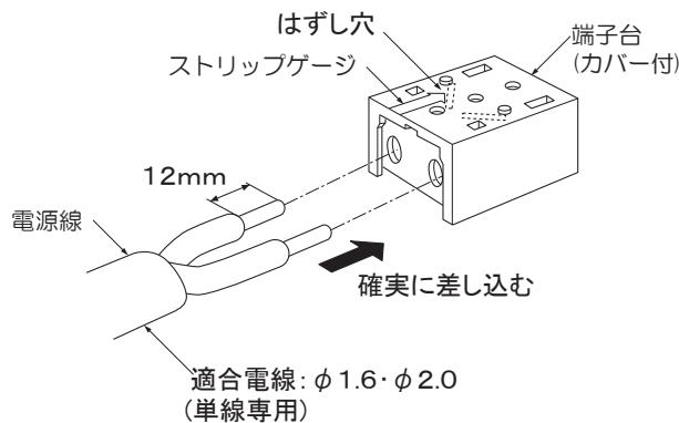
電源線を取り外す場合は、マイナスドライバー等をはずし穴に差し込み、電源線を引き抜く。
