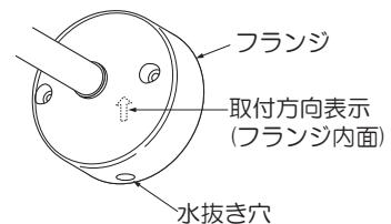
※水抜き穴に防水ブッキングが取付いていない事を確認してください。
