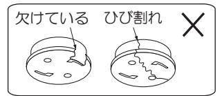
破損しているもの
