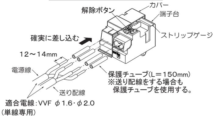
電源線を取外す場合は、マイナスイドライバー等で解除ボタンを押しながら、電源線を引き抜く。
