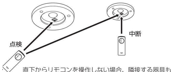
直下からリモコンを操作しない場合、隣接する器具も受信してしまうことがあります。その際は隣接する器具の直下から、リモコンの「中断」スイッチを押して点検を中断してください。
