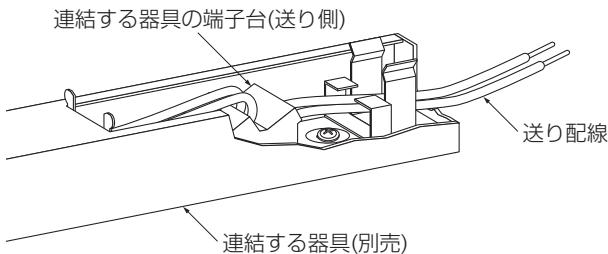
●送り配線を連結する本体の端子台(電源側)に確実に差し込む。
