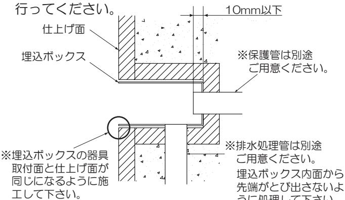
※埋込ボックスの器具取付面と仕上げ面が同じになるように施工して下さい。
