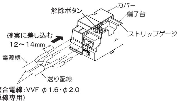
電源線を取外す場合は、マイナドライバー等で解除ボタンを押しながら、電源線を引き抜く。
