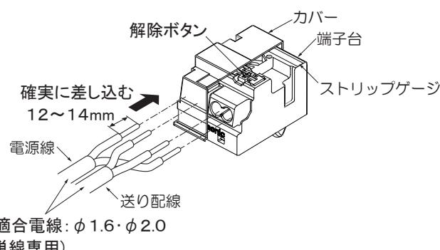
電源線を取り外す場合は、マイナスドライバー等で解除ボタンを押しながら、電源線を引き抜く。
