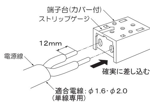
電源線を取り外す場合は、カバーを取り外し、マイナスドライバー等をはずし穴に差し込み、電源線を引き抜く。
