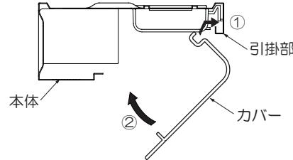
●片方の側板を押えながら、もう一方の側板を押し込み取付ける。
