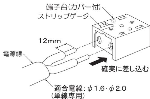
電源線を取外す場合は、カバーを取外し、マイナスドライバー等をはずし穴に差し込み、電源線を引き抜く。
