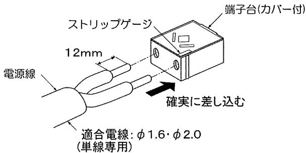
電源線を取り外す場合は、カバーを取り外してマイナスドライバー等をはずし穴に差し込み、電源線を引き抜く。
