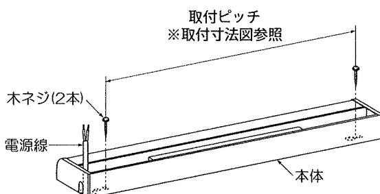
※壁面取付けの場合、取付方向は横長付け専用です。
