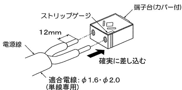
電源線を取外す場合は、カバーを取外してマイナスドライバー等のはずし穴に差し込み、電源線を引き抜く。
