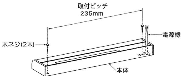
※ 壁面取付けの場合、取付方向は横長付け専用です。
