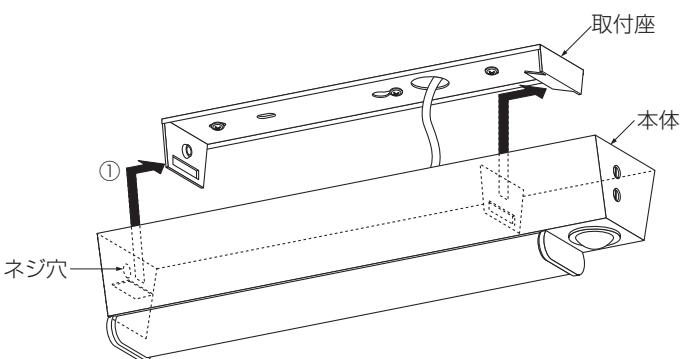
②本体取付ネジを確実に締め付け固定してください。
