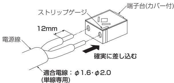
電源線を取外す場合は、カバーを取外してマイナスドライバー等をはずし穴に差し込み、電源線を引き抜く。
