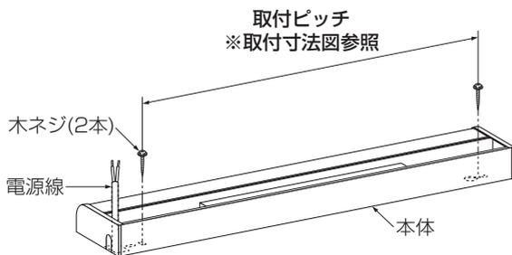
※ 壁面取付けの場合、取付方向は横長付け専用です。
