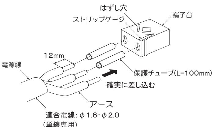
電源線を取り外す場合は、マイナスドライバー等をはずし穴に差し込み、電源線を引き抜く。
