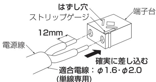
電源線を取外す場合は、マイナスドライバー等のはずし穴に差し込み、電源線を引き抜く。
