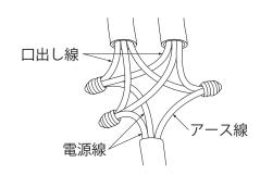
結線後、絶縁・防水処理を確 実に行ってください。処理が | いでください。火災・感電の 不完全な場合、火災・感電・絶 原因となります。 縁不良・漏電の原因となりま す。
