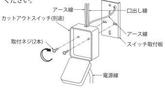
●ポール内の取付ネジ にスイッチ取付板を セットし、六角ナッ トで確実に締め付け 固定してください。 <sub>六角ナット</sub>
