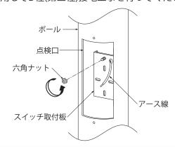
結線後、絶縁・防水処理を確 実に行ってください。処理が 不完全な場合、火災・感電・絶 縁不良・漏電の原因となりま す。
