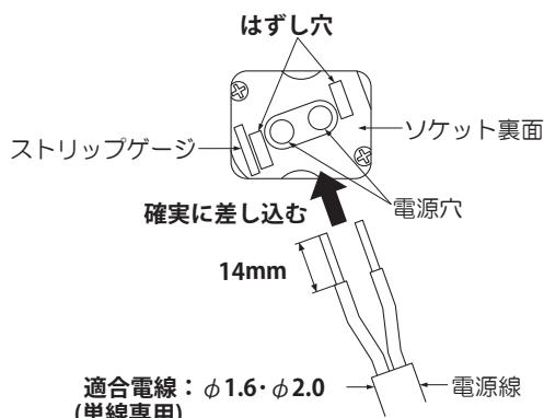
電源線を取り外す場合は、マイナスドライバー等をはずし穴に差し込み、電源線を引き抜く。
