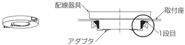
●取付座のセンター穴をアダプタに合わせ、天井に密着するまで確実に押し上げ固定する。
