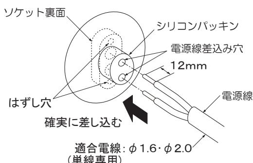
電源線を取り外す場合は、先端を20mm以上段むきしたφ1.6VVF線を2本同時にはずし穴に押し込みながら、電源線を引き抜く。
