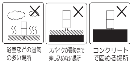
浴室などの湿気の多い場所 スパイクが最後まで差し込めない場所 コンクリートで固める場所
