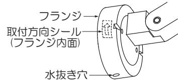
※水抜き穴に防水ブッシングが取付いていない事を確認してください。
