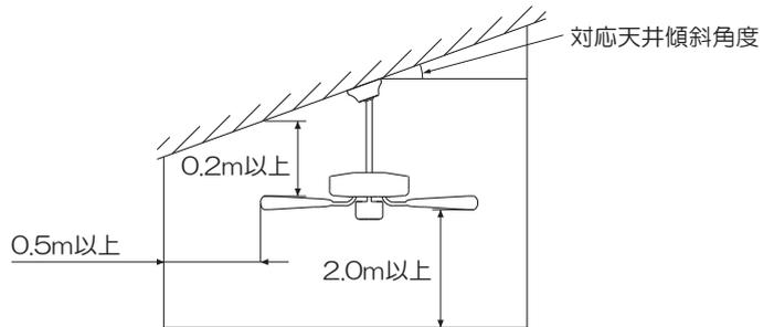
注) 傾斜天井に取付ける際は、必ず支柱の対応天井傾斜角度をご確認ください。
