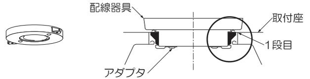
※アダプタの解除レバーの赤色が見えている場合は、取付座センター穴付近を再度押し上げてください。
