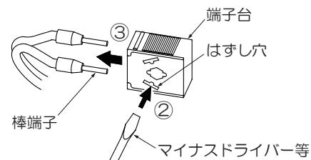
④⑤棒端子の下を切断し、本体から電源コードを引き抜いてください。
