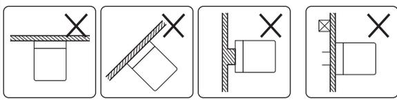
天井 傾斜壁面 不安定な場所 補強のない壁面 |
