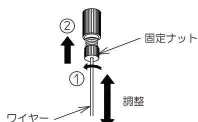
※調節後、固定ナットを確実に固定されているか確認してください。
