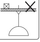
補強のない天井 |
