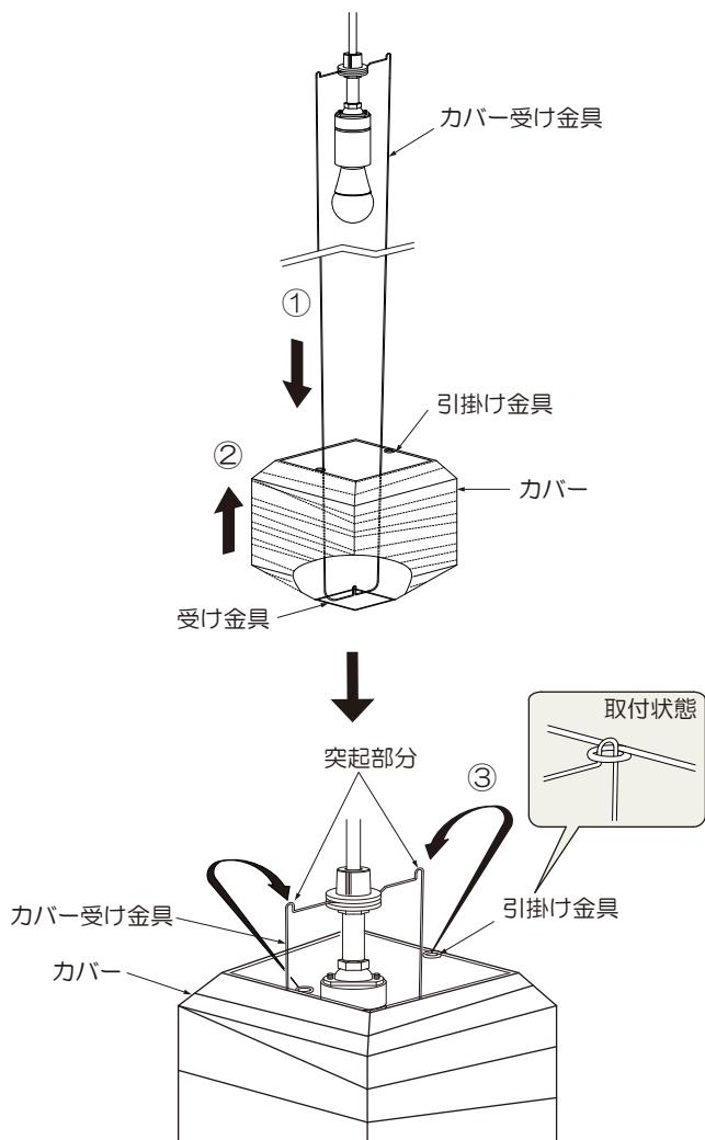
※カバーの向きを調整する場合は、カバー取付ナットを回して微調整してください。
