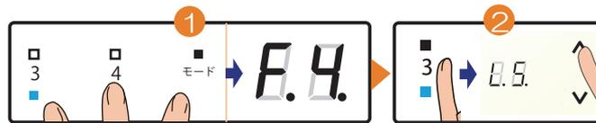
「3」・「4」ボタンとモードボタンを同時に3秒以上タッチします。デジタル表示部に「F4」が点灯し、シーン・回路選択の「4」ボタンが点滅します。これで負荷の設定モードが呼び出されました。
