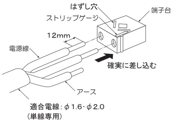
電源線を取外す場合は、マイナスドライバー等のはずし穴に差し込み、電源線を引き抜く。
