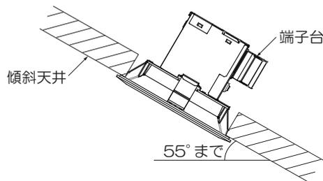
本体を取外す場合は、枠をゆっくり引き下げ、取付バネ(2本)を両手でせばめながら取外す。
