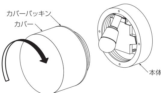
電源線を取り外す場合は、マイナスドライバー等をはすし穴に差し込み、電源線を引き抜く。
