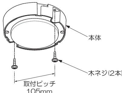
※壁面取付の場合は方向シールの表示に従って取り付け
