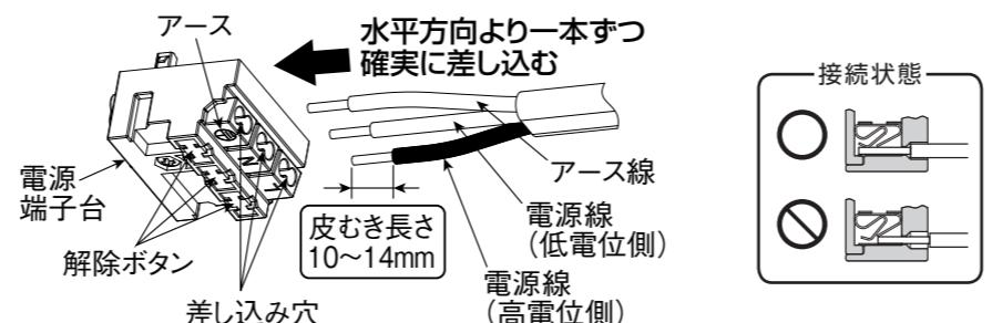
・電源線接続の速結端子の電源線を取り外すときは、幅6mmのマイナスドライバーで解除ボタンをまっすぐに押す。
