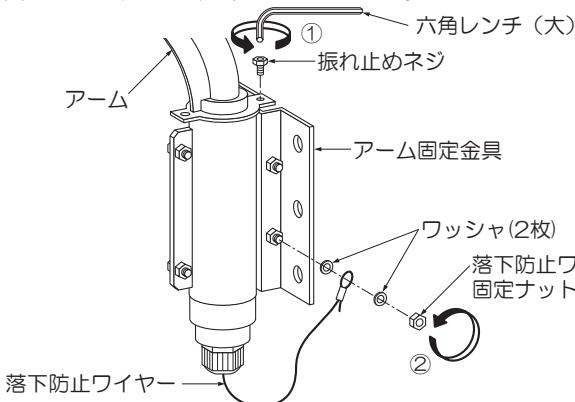
③アーム、落下防止ワイヤーから電源用防水コネクタ、アーム固定キャップを取り外してください。
