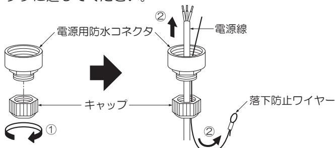
●電源線とアーム口出し線を確実に結線し、必ず絶縁・防水処理を行ってください。
