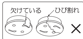
破損しているもの
