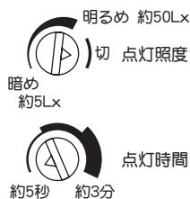
※昼間・夜間に関係なくセンサーの感知エリアに人が入ればランプが約5秒間100%で点灯し、その後、消灯します。
