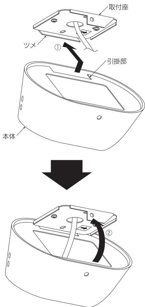
③本体をパッキン、本体取付ネジで確実に締め付け固定してください。
