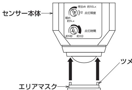
注) 感知エリアが広い場合はセンサー感知部に「エリアマスク」を取り付けて、感知エリアを調整してください。
